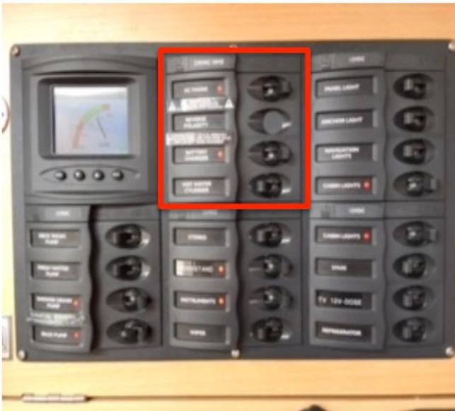
In diesem Segment des Panels befinden sich die Schalter für den Landanschluss (AC-Mains) nur wenn hier die Kontrollleuchte brennt, liegt auch tatsächlich Strom an.
