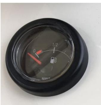
Den Dieselvorrat können Sie an dem Instrument neben dem Maschinen-Paneel überprüfen. Die Anzeige ist sehr langsam und braucht einige Minuten bis diese den tatsächlichen Füllstand anzeigt.
