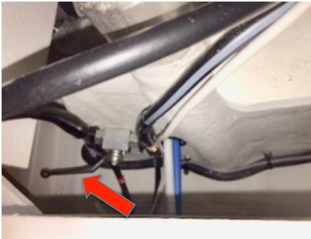
Das Ventil befindet sich links unterhalb des Ruderkoaks. Auf dem Foto ist das Ventil bereits geschlossen.
